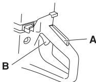
Фиксаторът на дроселната клапа остава в натиснато положение, докато се подава газ. При пускане на ръкохватката, регулаторът за газта и фиксаторът на регулаторът за газта се връщат в съответните си изходни положения. Това се постига чрез две независими една от друга възвратни пружини системи. При това положение регулаторът за газта автоматично се застопорява на празен ход.
