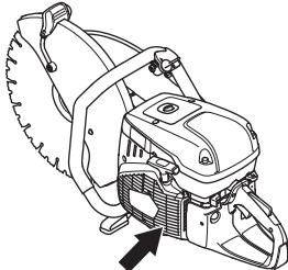
**ИЗВЕСТИЕ!** Замърсен или блокиран смукателен въздухопровод предизвиква прегряване на машината, което води до повреждане на буталото и цилиндъра.
