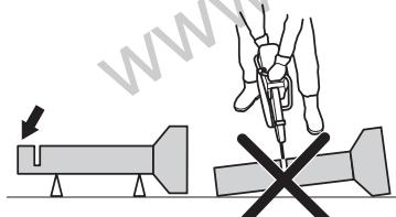
Ако тръбата провисне и затвори прореза, режещият диск ще бъде защищен в зоната на откат и е възможно да възникне силен откат. Ако тръбата е добре застопорена, краят на тръбата ще се движи надолу, прорезът ще се разтваря и няма да се получи защищване.
